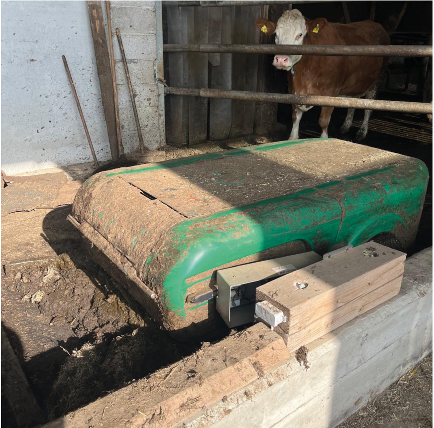
Abb. 2: Miroboter an der Ladestation
