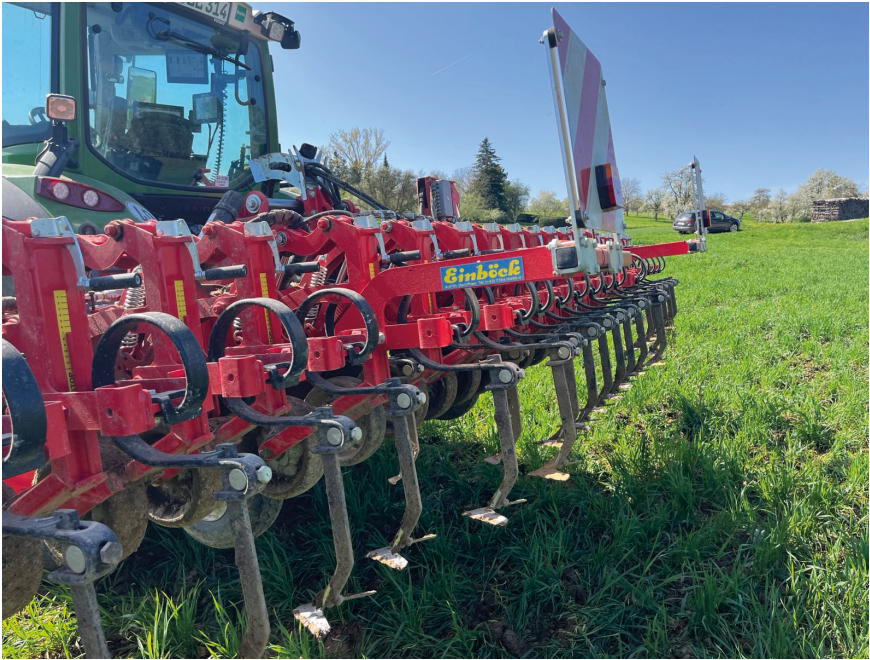
Abb. 3: Hackanhänger mit kameragesteuerter Spurenfindung
